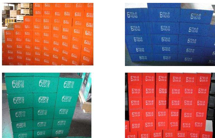
Рисунок 2 – Защитное покрытие, нанесенное на огнеупоры для сталеразливочных ковшей поставки ОАО «БКО»
