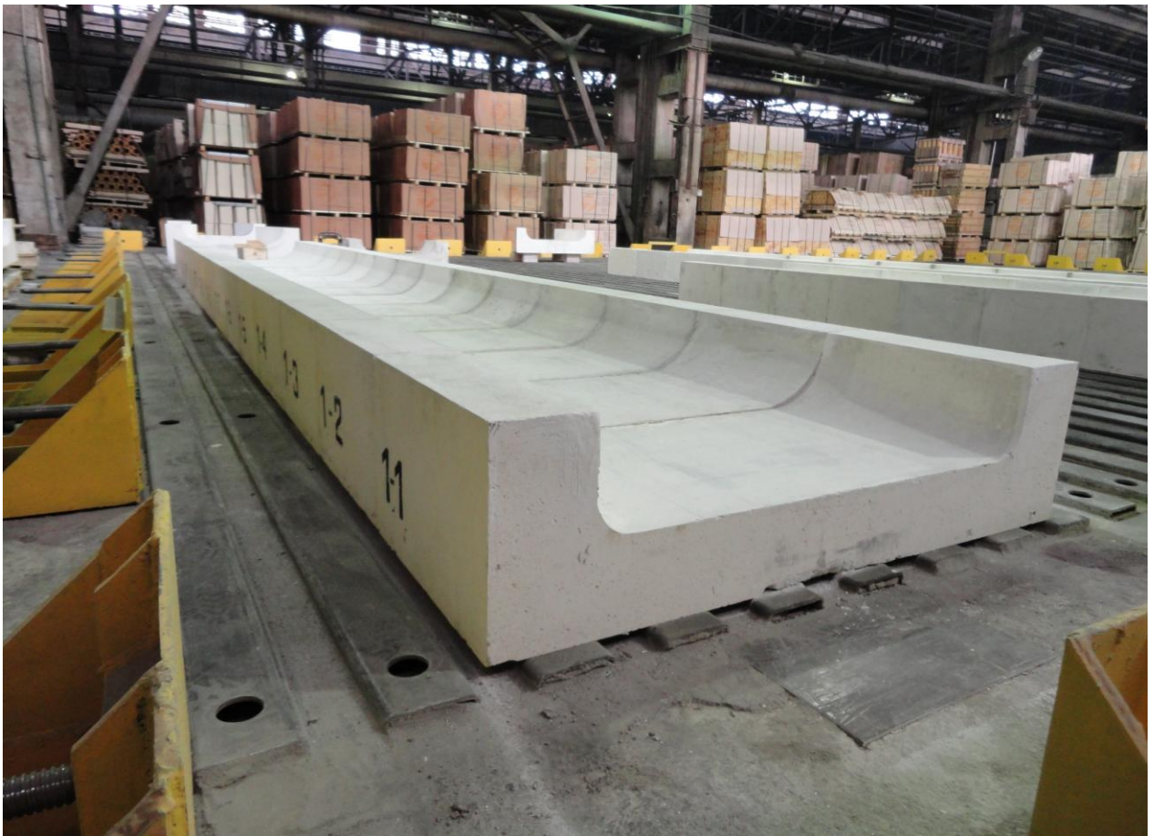
Рис. 7 – Сборка на стенде лотка-питателя стеклоформирующей машины.
