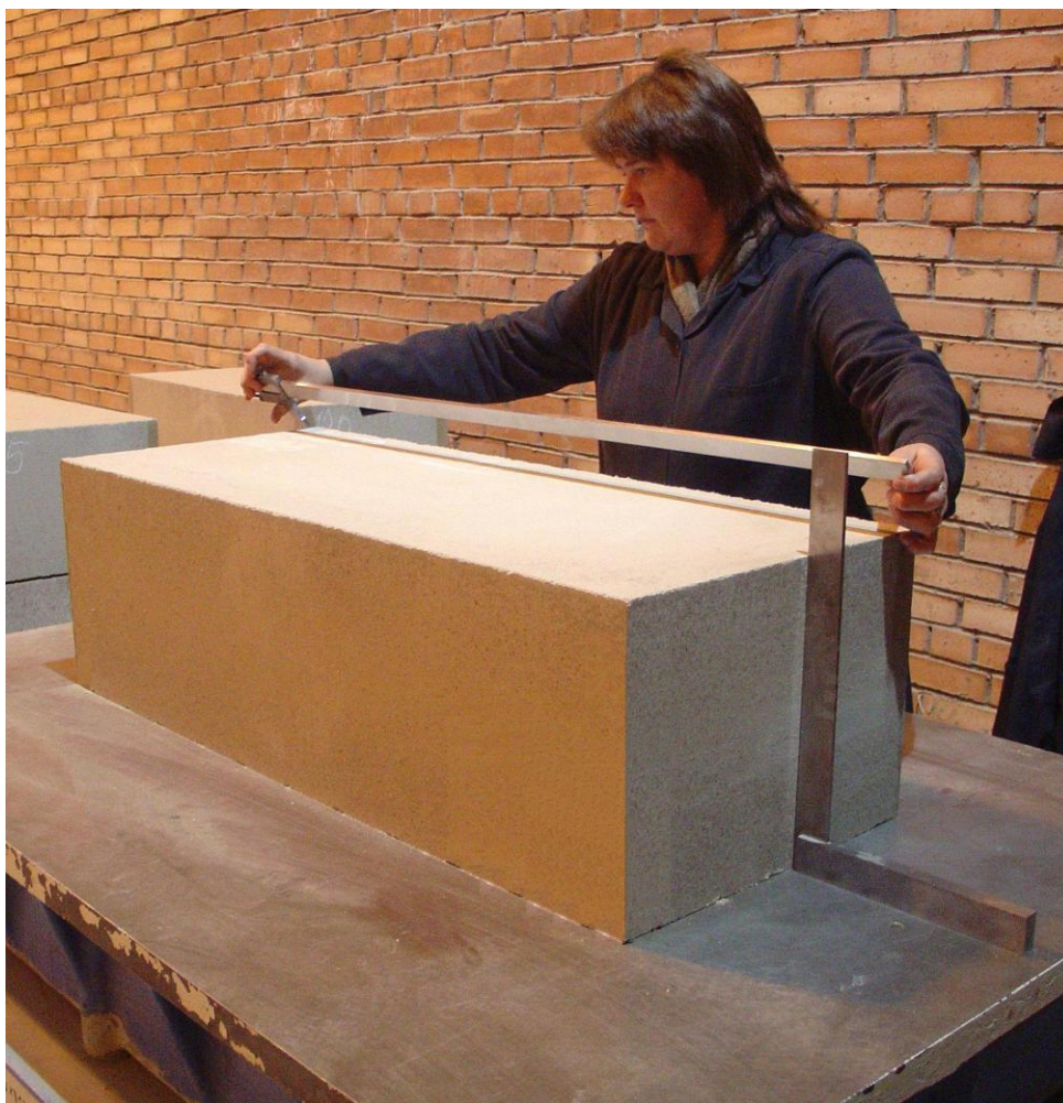
Рис. 4 – Контроль размеров и уклонов изделий после шлифования.
