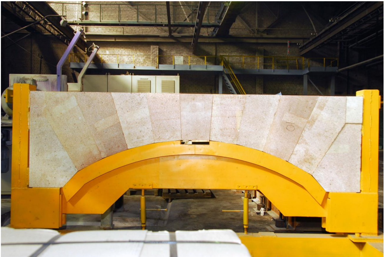
Рис. 6 – Стенд для сборки арок с собранным на нём арочным сводом.
