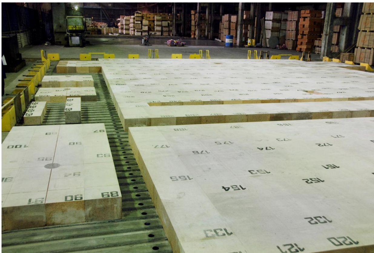
Рис. 4 – Сборка днища под загрузочным карманом отдельно от зоны варки.
