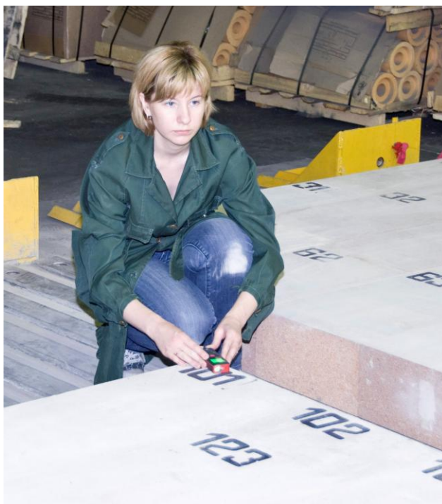
Рис. 5 – Проверка линейных размеров лазерным дальномером.
