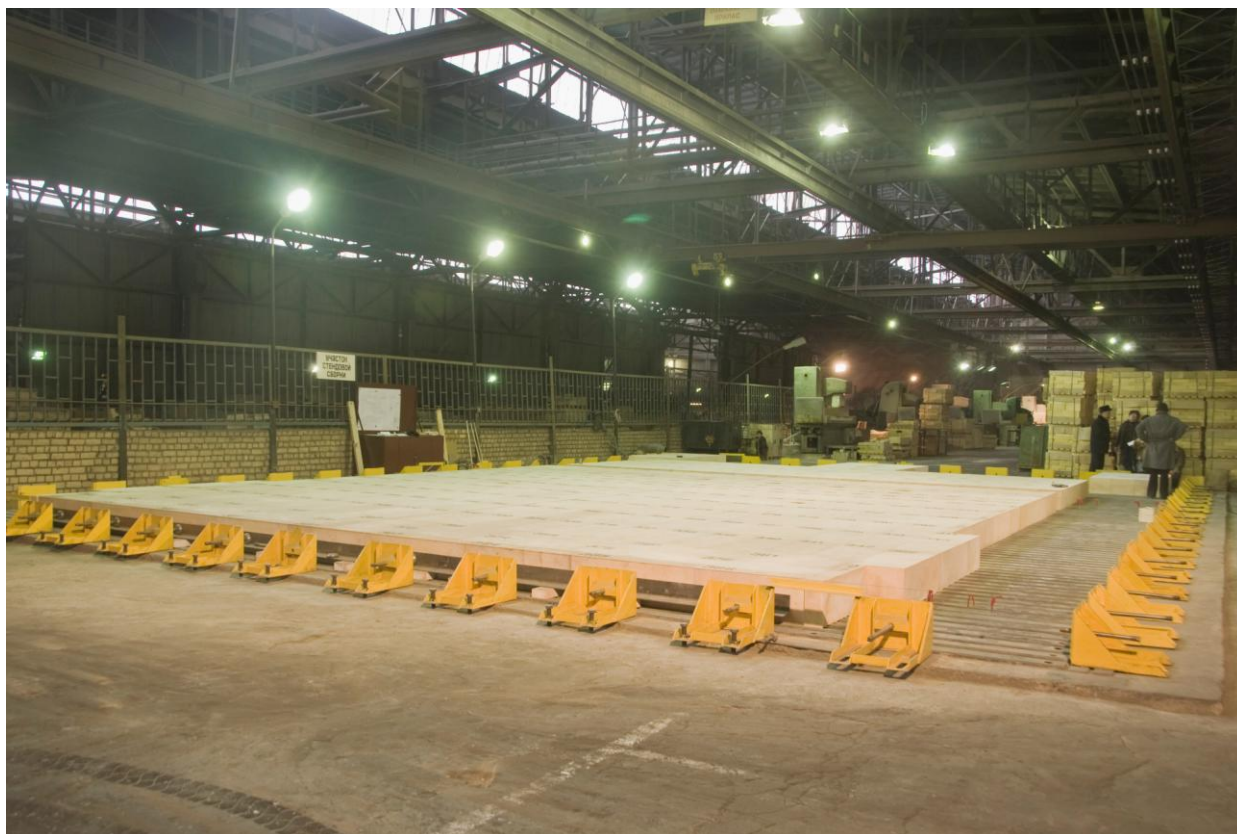
Рис. 1 – Стенд на складе готовой продукции цеха стелеразливочного припаса ОАО «БКО» с собранным днищем стекловаренной печи.
