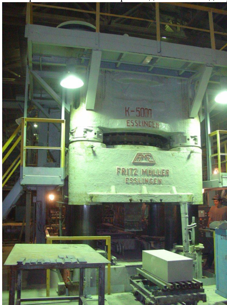
Рис. 2 – Гидравлический пресс для прессования донного бруса.
