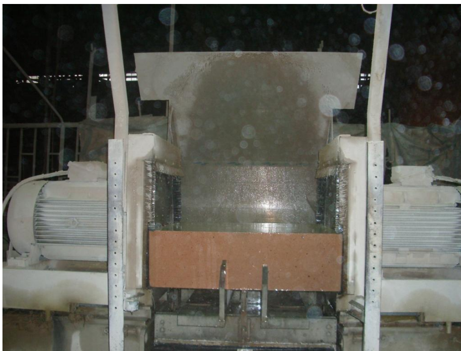
Рис. 3 – Шлифование донного бруса на станке Wassmer.
