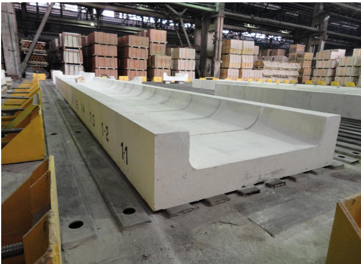
Рис. 6 – Сборка на стенде лотка-питателя стеклоформирующей машины.
