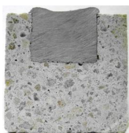
Рисунок 4. Смачивание расплавом алюминия бетона с уплотненной структурой без использования несмачивающей добавки.
