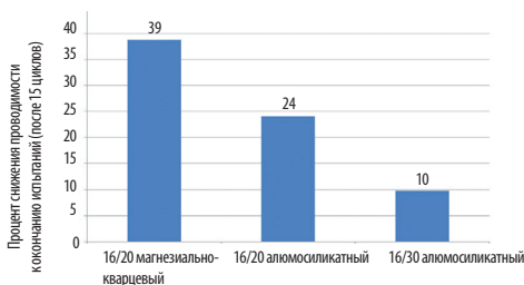
Рис. 4. Сравнение уменьшения проводимости пропантной пачки (в %) по окончании испытания на циклические нагрузки (после 15 циклов)
