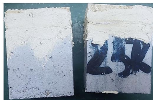
Рис. 1. Типичный внешний вид образцов бетона до (а) и после испытаний (б) на устойчивость к щелочам по методу ВО
